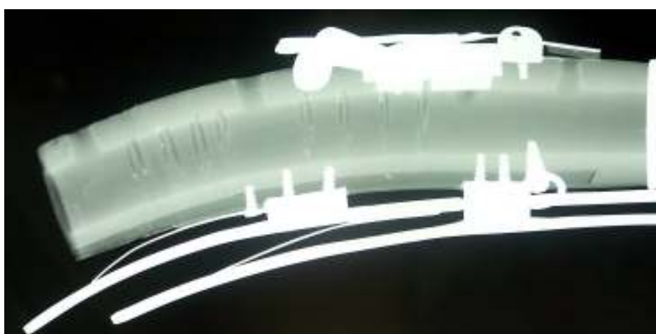
III. 4 – Radiographies de la fixation des chevalets « A MELINGUE Paris »
